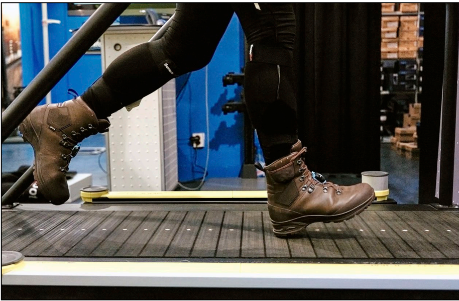
Afb. 2: Het optische meetsysteem Optojump (gele balken), geplaatst aan weerszijden van de loopband met lamellen. De blauwe Runscribe-sensor (zie ook Afb. 3) is nog net zichtbaar op beide laarzen, vastgemaakt aan de veters. Let op: De afbeelding toont een militair (niet de proefpersoon) met een duidelijke haklanding op laarzen. Foto: LaFoot, Hilversum.
