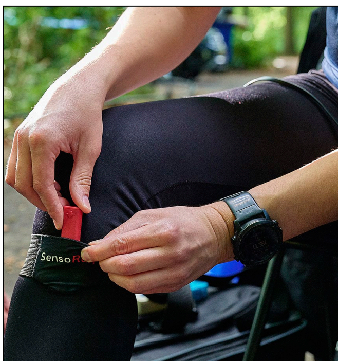
Afb. 1: De Sensorun-sensor, geplaatst op de proximale tibia. Foto: LaFoot, Hilversum.
