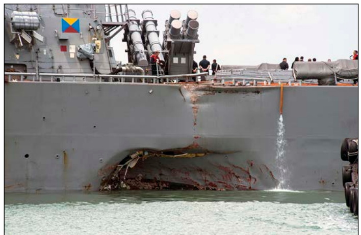
Afb. 14: Schade USS John S. McCain na aanvaring met de onder Liberiaanse vlag varende Alnic MC.
