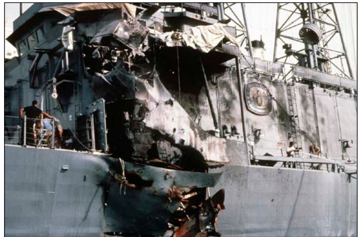
Afb. 6 en 7: Een beeld van de schade opgelopen door USS Stark toen het werd geraakt door twee door Irak gelanceerde Exocet-raketten tijdens een patrouille in de Perzische Golf (1987). Foto: US Navy, publiek domein.
